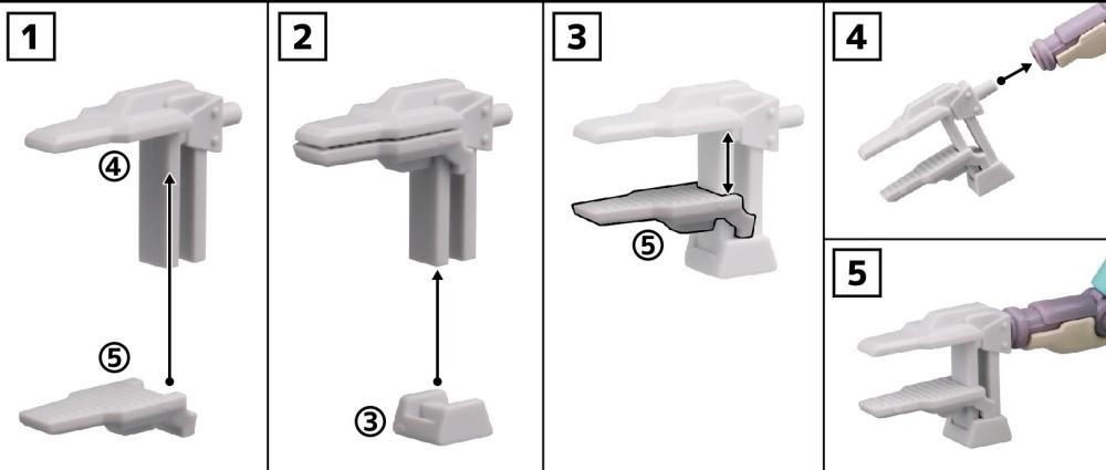
[1] ④のパーツに⑤を取り付けます。[2] ④で組み立てたパーツに③のパーツを取り付けます。[3] ⑥のパーツは図のように可動します。[4] 図のようにハンドパーツを取り付けます。[5] 取り付け見本です。
